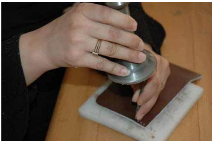
مشته: برای ضربه زدن روی سنبه و ایجاد سوراخ
