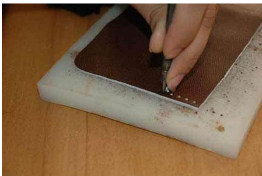
مشته: برای ضربه زدن روی سنبه و ایجاد سوراخ
